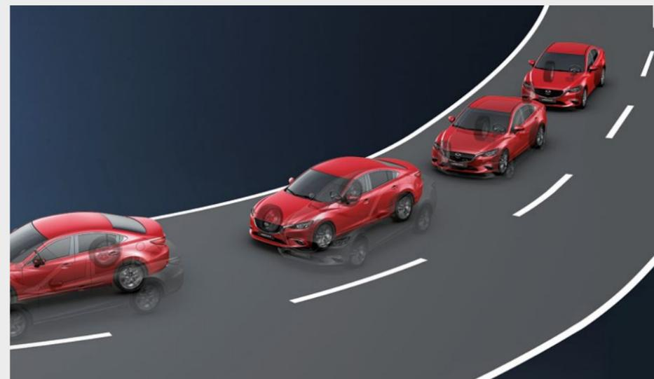
G-VECTORING CONTROL: FAHRDYNAMIKREGELUNG FÜR OPTIMALE RADLASTVERTEILUNG BEI KURVENFAHRTEN UND VERBESSERTEN GERADEAUSLAUF
